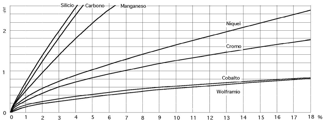
Fig I.8.- Factores de corrección de la conductividad térmica de los aceros aleados
