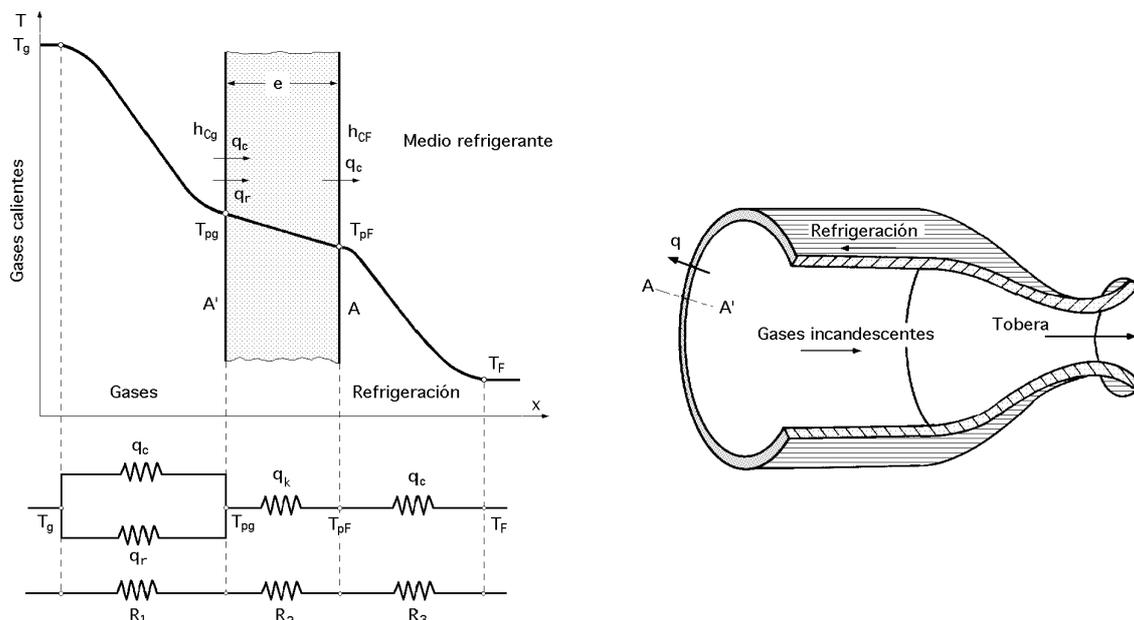
Fig I.14.- Transmisión de calor en la cámara de combustión de una turbina de gas
