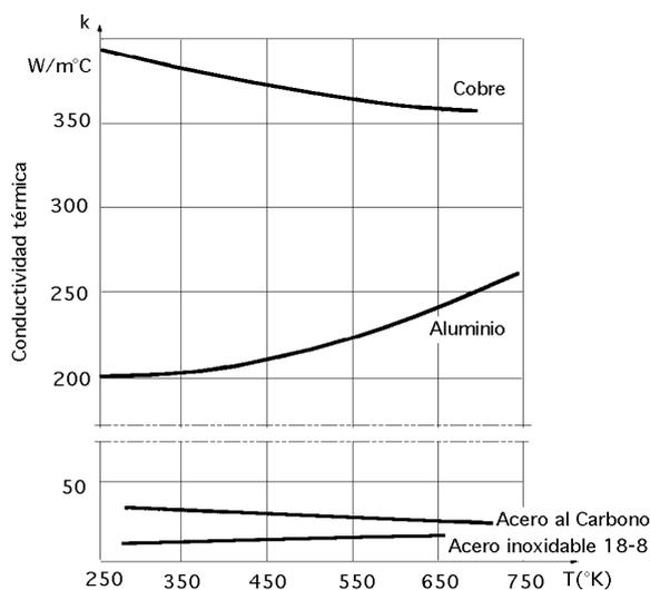
Fig I.6.a.- Conductividad térmica metales y aleaciones
