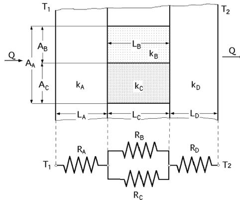
Fig I.5.- Circuito térmico en serie-paralelo-serie
