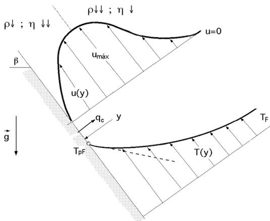
Fig I.10.- Distribución de la temperatura y la velocidad en convección natural sobre una placa plana inclinada
