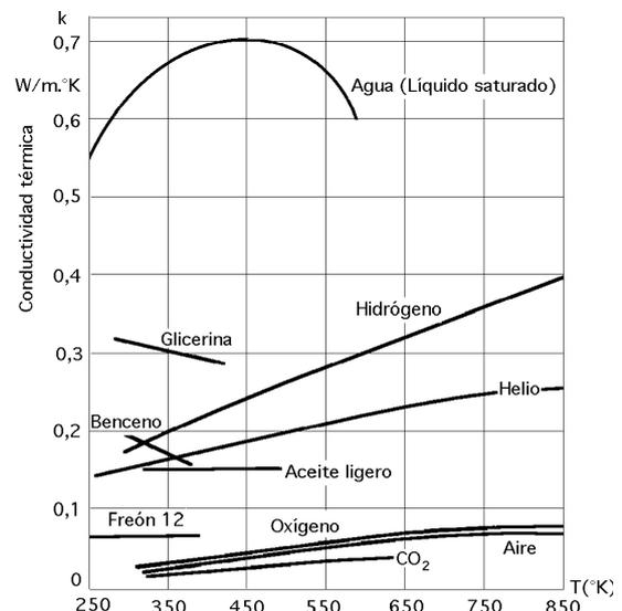
Fig I.6.b.- Conductividad térmica líquidos, gases y vapores
