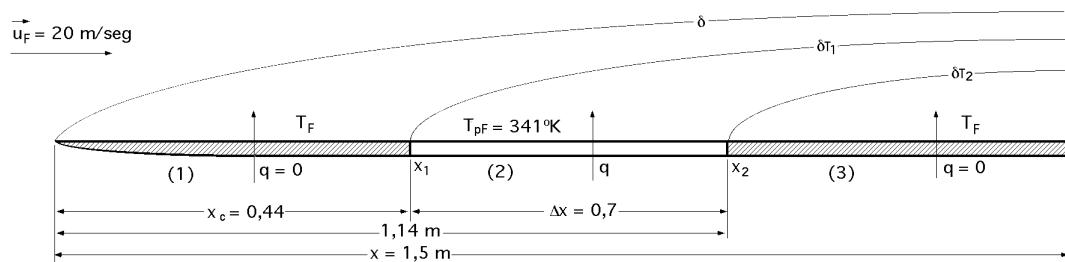
$$\text{Propiedades del aire: } T = \frac{T_{pF} + T_F}{2} = \frac{341 + 285}{2} = 313^\circ\text{K}$$
