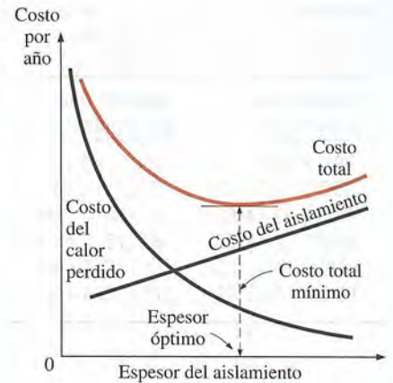
FIGURA 7-38 Determinación del espesor óptimo del aislamiento considerando el costo total mínimo.
