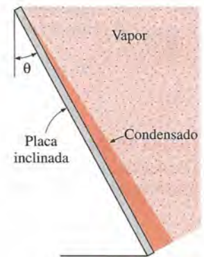
FIGURA 10-27 Condensación en película sobre una placa inclinada.
